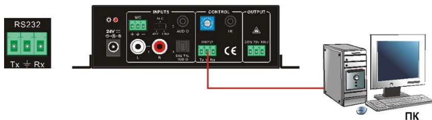
Рис 10 Подключение по порту RS232
