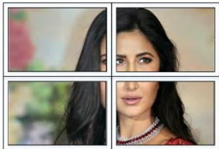
Компенсация беззеля отсутствует
