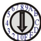
Рис. 5 Поворотный переключатель на задней панели передатчика/приёмника.
